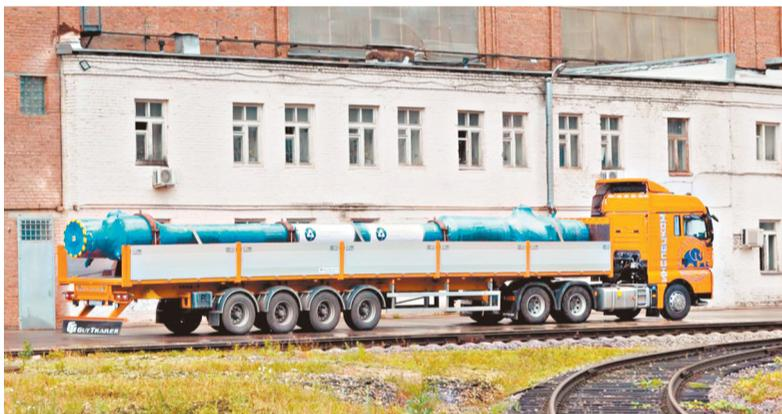
«На Белоярскую атомную станцию доставлен комплект из восьми модулей испарителя парогенератора
