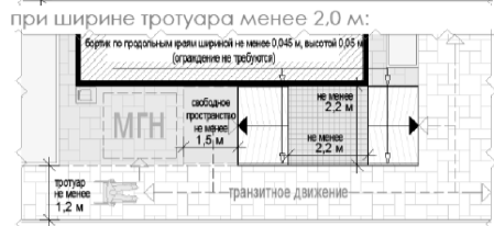
СХЕМЫ ОСНОВНЫХ ПАРАМЕТРОВ ВХОДНОЙ ГРУППЫ ДЛЯ ПОКУПАТЕЛЕЙ ПРИ ВЫСОТЕ ВХОДНОЙ ПЛОЩАДКИ ОТ УРОВНЯ ЗЕМЛИ ОТ 0,45 м;
