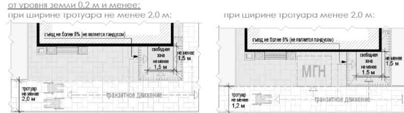
схемы основных параметров входной группы для покупателей при высоте входной площадки от уровня земли 0,2 м и менее:
