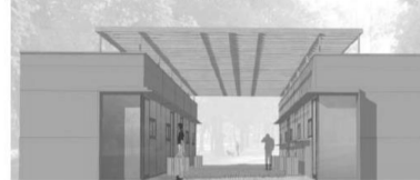
СХЕМА ТОРГОВОЙ ГАЛЕРЕИ С ВЫСОТОЙ ВХОДНЫХ ПЛОЩАДОК НГО ОТ УРОВНЯ ЗЕМЛИ БОЛЕЕ 0,2 м;
